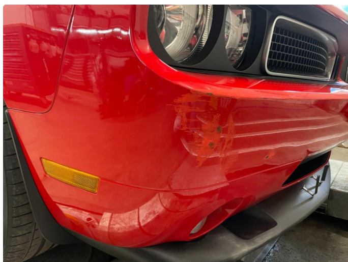
1.7 Lakkskade fanger. blir opplakkert hos INTAKT. Time bestilt
