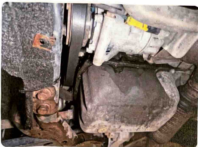
4.2 Oljelekkasje fra motor Oljelekkasje motor, trolig sim-ring reimhjul veiv.
