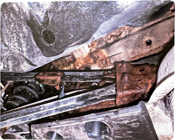
3.1 Rust Mye rust underside ved bakstilling.
