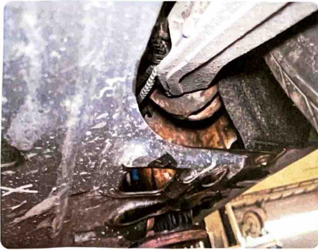
3.1 Rust Mye rust underside ved bakstilling.
