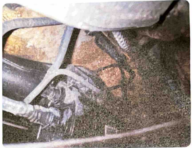
3.1 Rust Mye rust underside ved bakstilling.
