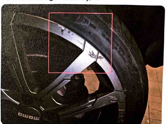
3.10 Kantkjørt felg Alle sommerfelger er kantkjørt.
