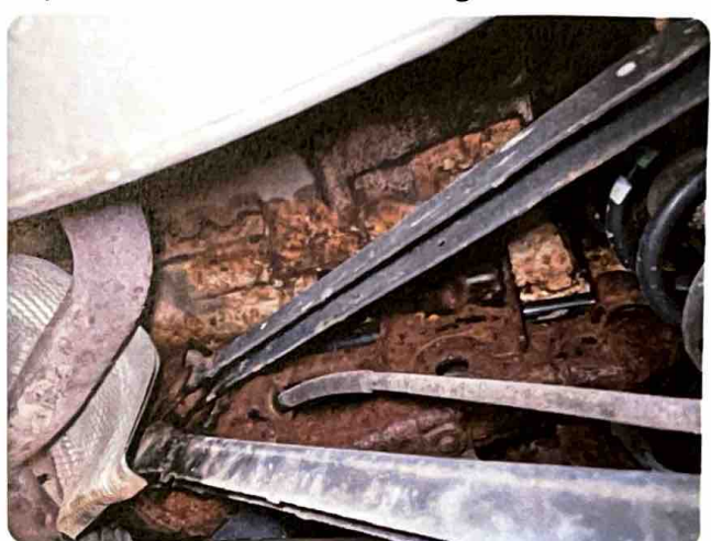
3.1 Rust Mye rust underside ved bakstilling.
