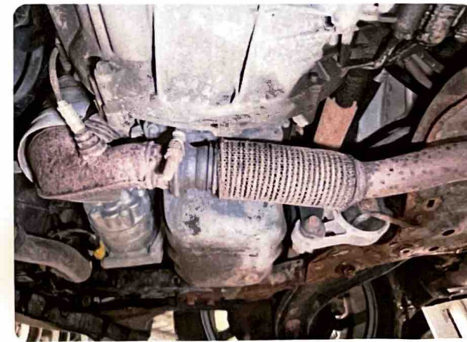
4.1 Skade på flexirør Noe løs flexikobling , ingen lekkasje pr. nå.
