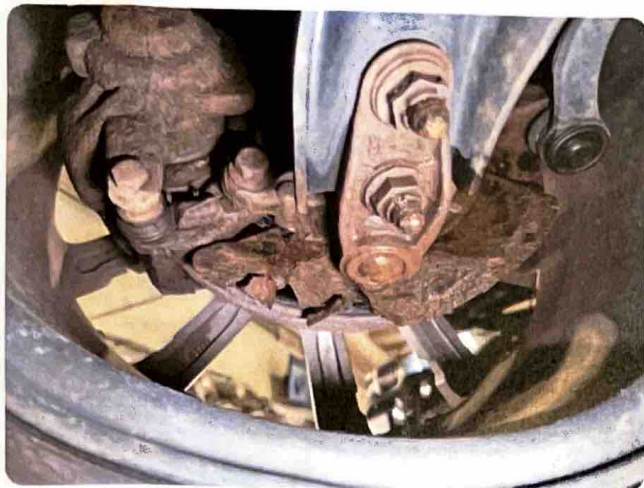
6.3 Gjennomrustet Gjennomrustet bremseskjold h-fram.
