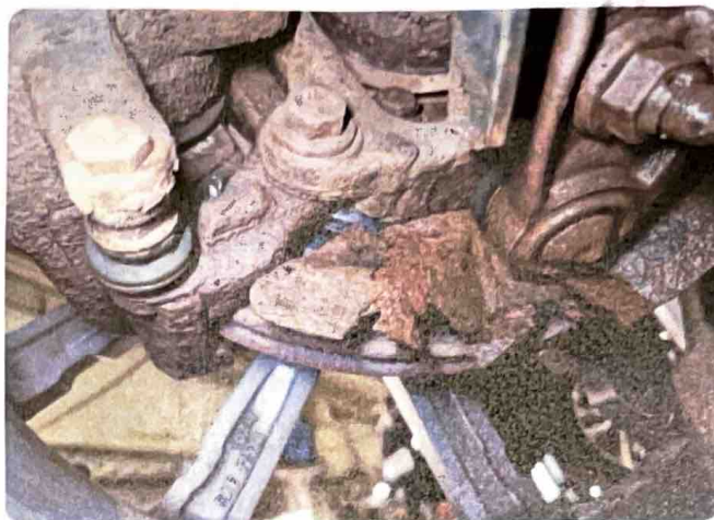
6.3 Gjennomrustet Gjennomrustet bremseskjold h-fram.
