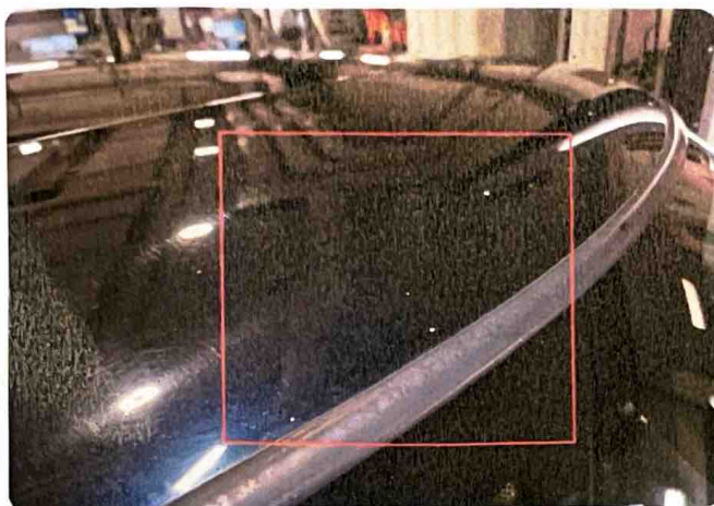
3.14 Steinsprut Noe steinsprut fremre del tak.
