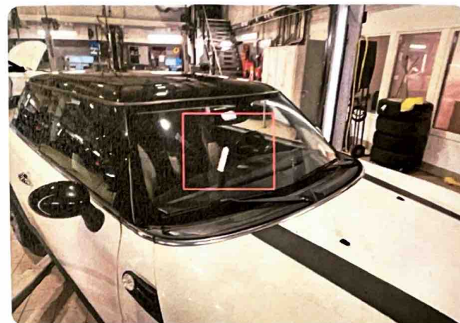
3.15 Steinsprut Steinsprut / slitasje frontrute.
