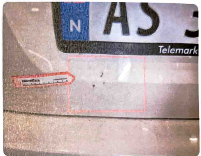
3.4 Rust/korrosjon Rust bakluke.
