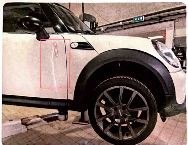
3.3 Bulk Flere bulker h-framdør.
