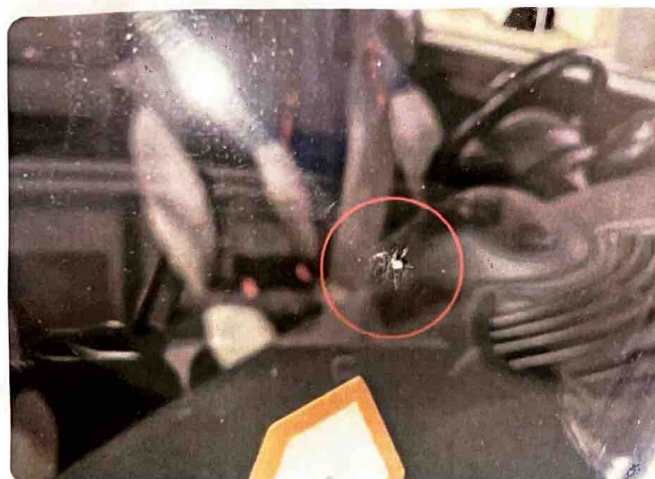
3.15 Steinsprut Steinsprut / slitasje frontrute.
