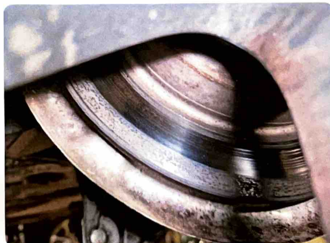
6.2 Rust Rust + slitasje bremseskiver bak, bremsklosser målt til 8mm.
