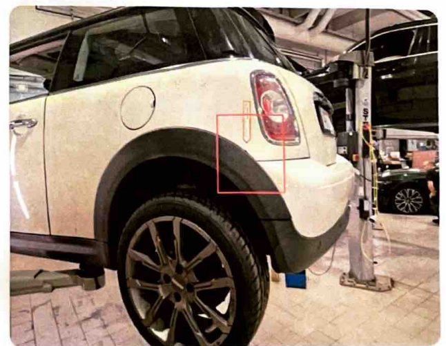
3.6 Rust Rust v-bakskjerm .
