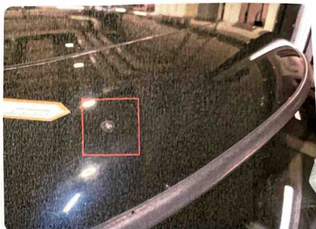
3.14 Steinsprut Noe steinsprut fremre del tak.
