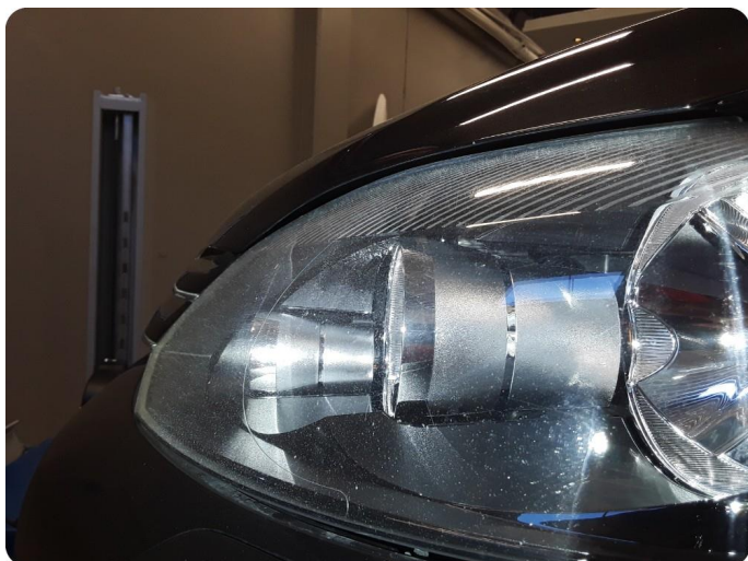
3.2 Krakelering i plast
